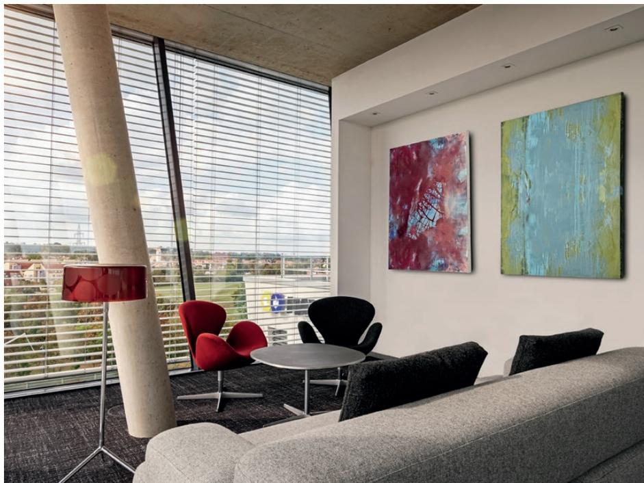
Fenster-System-Raffstoren helfen, ein Aufheizen der Räume durch Sonneneinstrahlung zu verhindern und ermöglichen gleichzeitig, ein Maximum an Tageslichtnutzung. (Foto: Warema)
